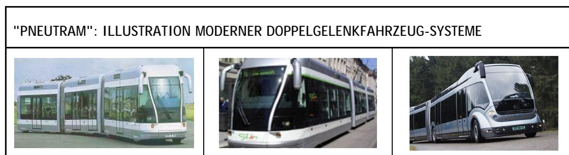
Figur 2 Linkes Bild: Doppelgelenk-Pneufahrzeug System Translohr; mittleres Bild: Doppelgelenk-Pneufahrzeug, wie es in Nancy und Caen (Frankreich) eingesetzt wird; rechtes Bild: Doppelgelenk-Pneufahrzeug Phileas (Eindhoven, Holland).
